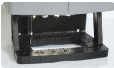
Подсветка рабочей области для удобства позиционирования маркиратора в местах с недостаточной освещенностью
