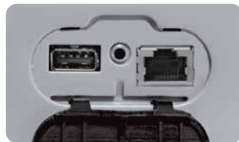
Встроенные защищенные разъемы USB и Ethernet для простого и быстрого импорта и экспорта данных
