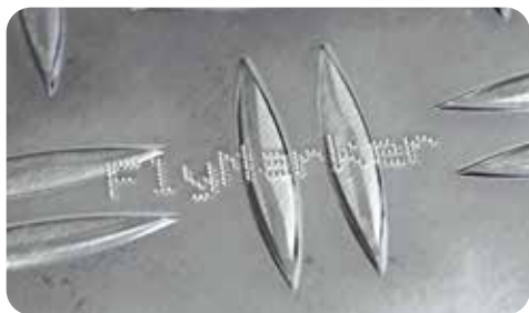
Равномерная маркировка поверхностей с перепадом высоты до 5 мм
