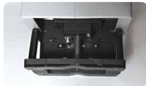
Установочный угол с призмами для простой маркировки круглых деталей (радиальных и осевых)
