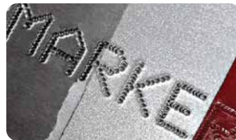
Глубокая маркировка для хорошей читабельности даже после покраски
