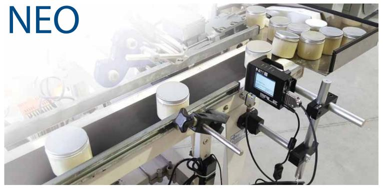
Термоструйный маркиратор NEO – компактная модель, использующая картриджи HP45 для нанесения информации на пористую и непористую поверхность высотой до 12,7 мм.
